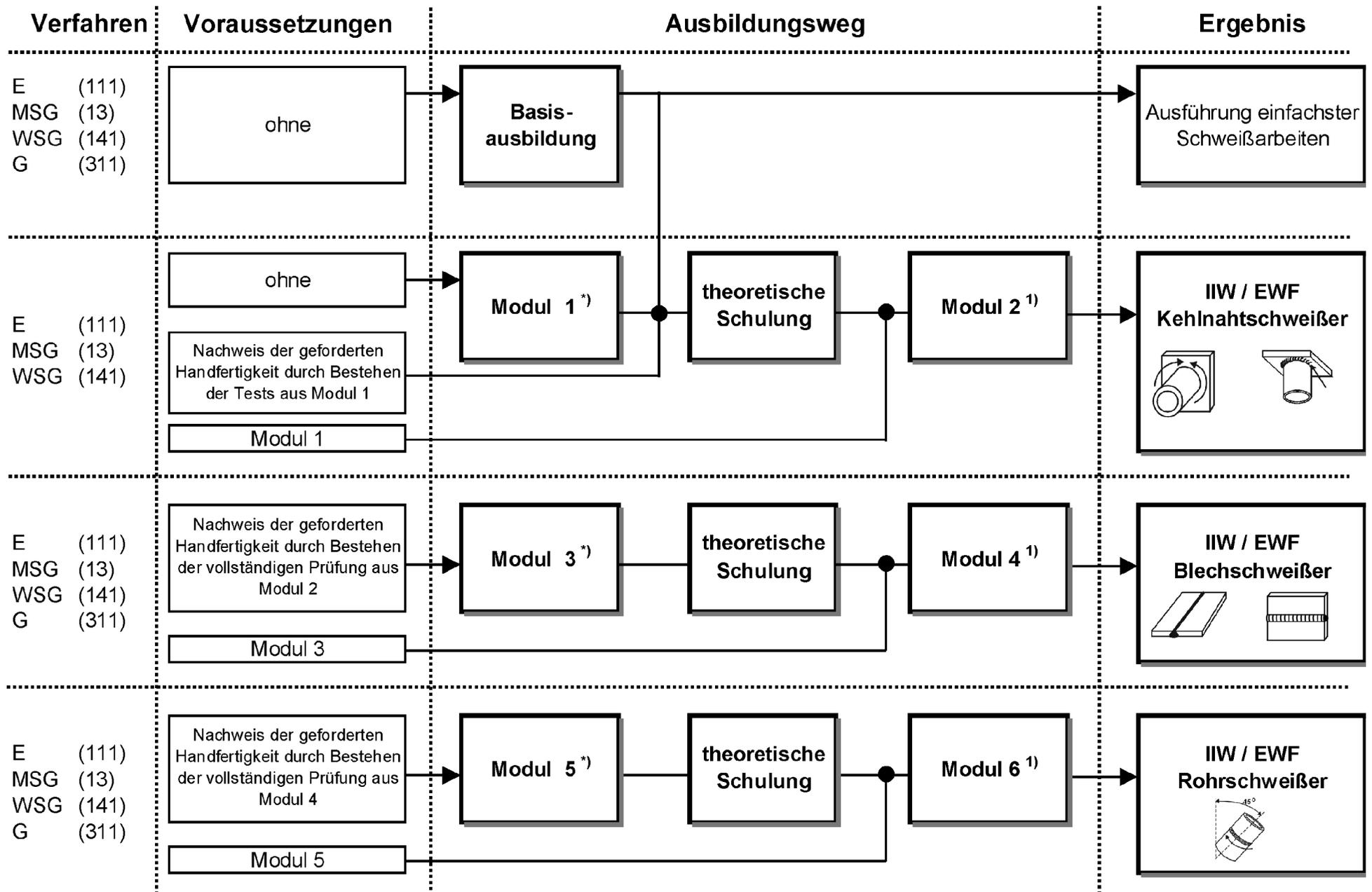
\*) Das Ablegen einer Schweißerprüfung, z. B. nach DIN EN 287 kann auf Wunsch erfolgen.
